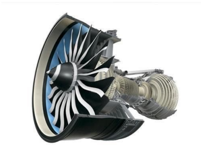
图 1 航空发动机的复合材料风扇叶片 [38] Fig. 1 Composite fan blades for aero-engines [38]
